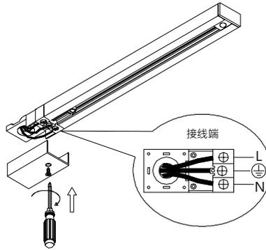
5. 将电源线按图所示正确连接轨道电源头·并安装好轨道电源头上盖。
