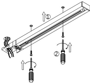
4. 选择合适的工具将零件包螺丝和轨道安装在(图一预设安装孔)孔内·并锁紧·将外部电源穿过轨道电源头进线口。
