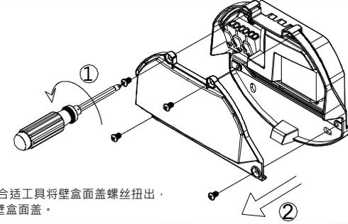
2. 选择合适工具将壁盒面盖螺丝扭出, 取下壁盒面盖。
