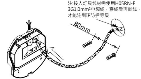
注: 接入灯具线材需使用H05RN-F 3G1.0mm²电缆线, 穿线后再剥线, 才能连到IP防护等级
