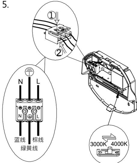
5. 将穿过壁盒防水塞的电缆线连接上灯具输入端子, 接好端子后如图所示调节所需的色温。
