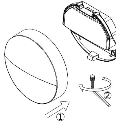
7. 将灯具前面板装回灯具本体并用内六角螺丝将面板锁紧。
