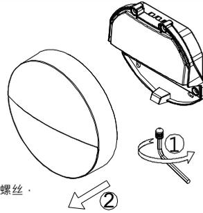
1. 用内六角扳手松开灯具底部螺丝, 取出灯具前面板。
