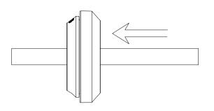
电源线穿透防水塞并接上灯具后, 将电源线外推收线,同时将防水 塞进线口向外翻转。
