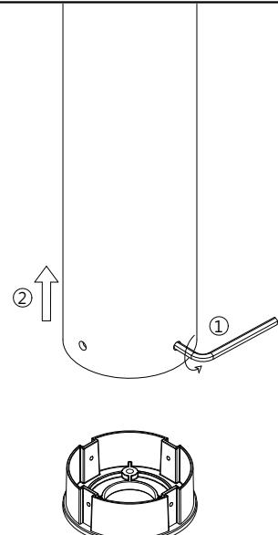
1. 断开电源·将壁盒后座从灯具底部取出。
