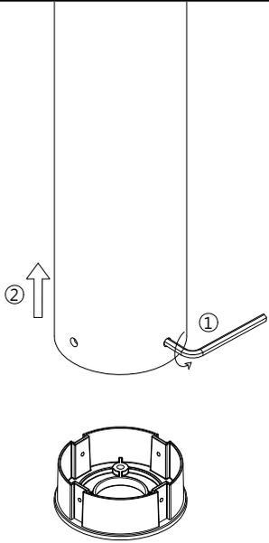
1. 断开电源·将壁盒后座从灯具底部取出。
