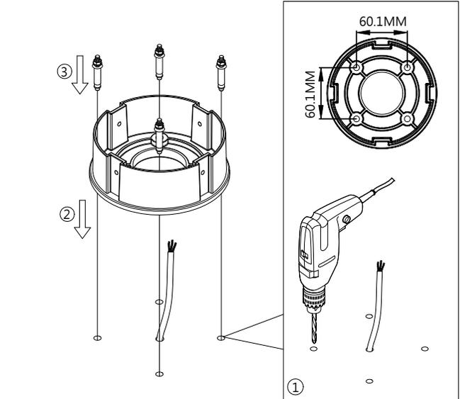
2. 按图示尺寸·将底座安装在安装面上。
