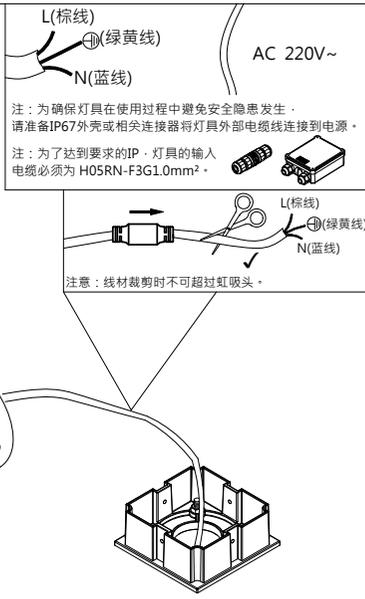
注: 为确保灯具在使用过程中避免安全隐患发生·请准备IP67外壳或相关连接器将灯具外部电缆连接到电源·
